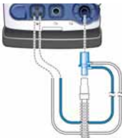
图 5-8. 安装流量传感器，nCPAP-PS 模式
