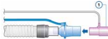
图 2-13. 将 CO2 传感器 (1) 连接至气道
