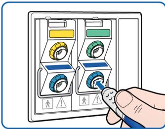
Abbildung 2-5. Anschließen des Sensorkabels am Nihon Kohden-Adapter
