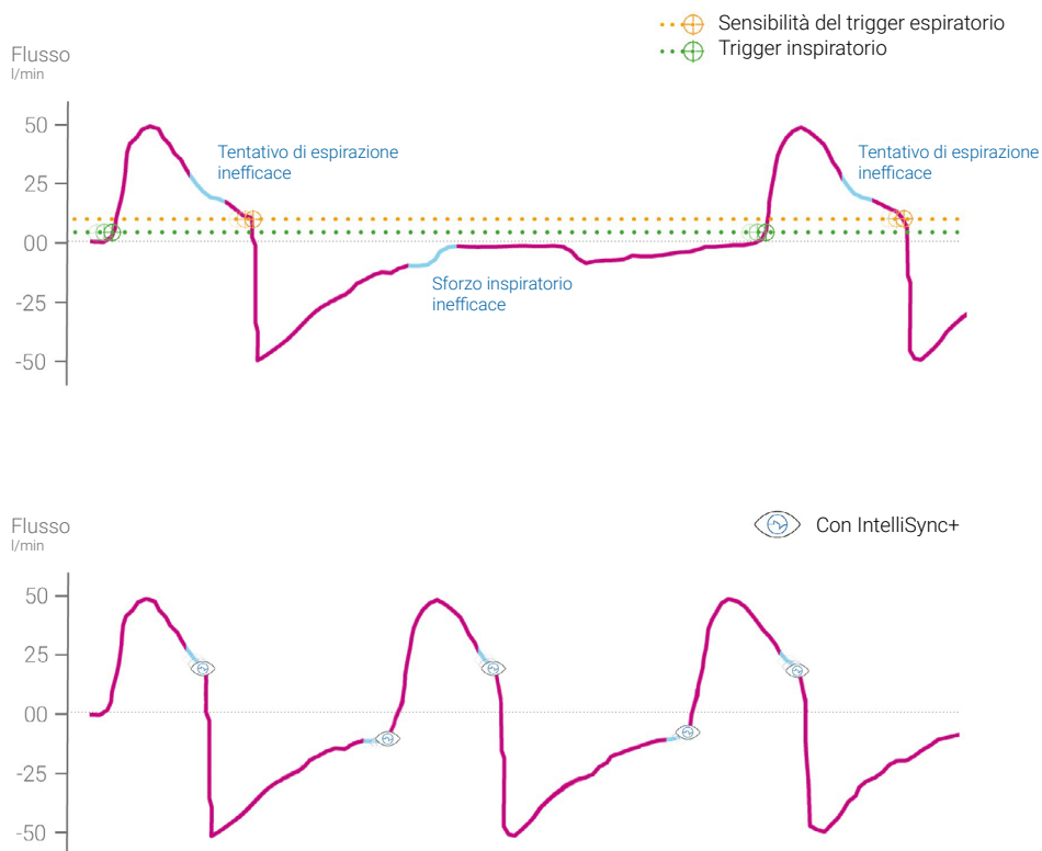
Fig. 6: Curva del flusso con IntelliSync+ attivato
