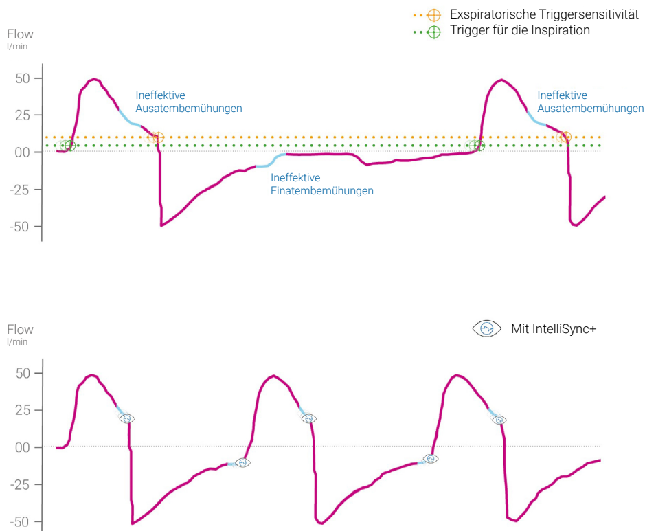
Abb. 6: Flowkurve mit aktiviertem IntelliSync+
