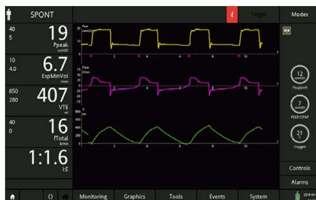
Figura 8: el mismo paciente ventilado con sensibilidad de disparo inspiratorio: 2 l/min; sensibilidad de disparo espiratorio: 25 %; rampa: 75 ms (arriba); y tras ralentizar la rampa a 175 ms (abajo). Preste atención al aumento de tiempo necesario para alcanzar el valor máximo inspiratorio y el retraso espiratorio cada vez mayor con un esfuerzo ineficaz (flecha).
