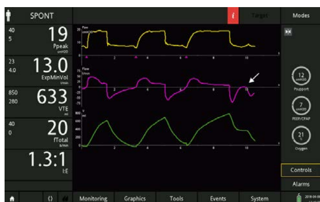
Figura 8: el mismo paciente ventilado con sensibilidad de disparo inspiratorio: 2 l/min; sensibilidad de disparo espiratorio: 25 %; rampa: 75 ms (arriba); y tras ralentizar la rampa a 175 ms (abajo). Preste atención al aumento de tiempo necesario para alcanzar el valor máximo inspiratorio y el retraso espiratorio cada vez mayor con un esfuerzo ineficaz (flecha).
