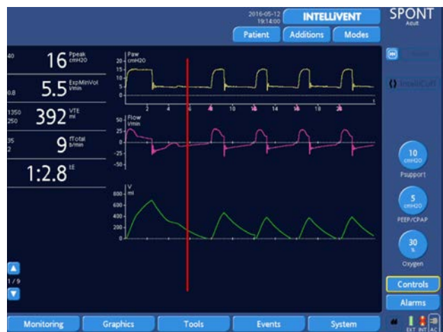
Figura 14: el mismo paciente simulado, pero usando el IntelliSync+ (línea roja); se inicia con el nivel inicial de la PS y el ajuste predeterminado de la ETS. Este se ajusta de forma inmediata a la actividad del paciente, lo que solventa casi por completo el problema de los ciclos tardíos.
