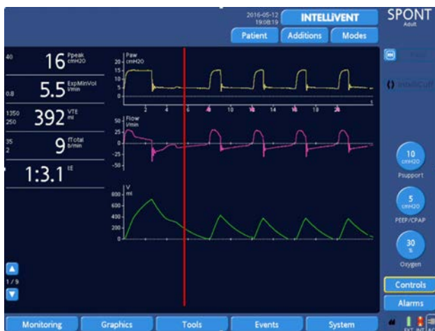
Figura 12: optimización (línea roja) de la ETS por parte del personal sanitario (ETS: 50 %); preste atención a la corrección del ciclo tardío y, por ende, a la eliminación de los esfuerzos ineficaces.
