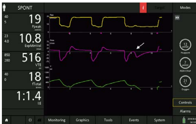
Figura 9: el mismo paciente ventilado con sensibilidad de disparo inspiratorio: 2 l/min; sensibilidad de disparo espiratorio: 25 %; rampa: 75 ms (arriba); inmediatamente tras modificar la ETS al 10 % (centro; línea roja) y tras algunas respiraciones con la ETS al 10 % (abajo). Preste atención a la prolongación de la inspiración que acompaña a un ciclo tardío evidente durante la primera respiración tras la modificación de los ajustes (flecha roja) y al efecto en la fase de disparo, que da lugar a esfuerzos ineficaces (flechas blancas).
