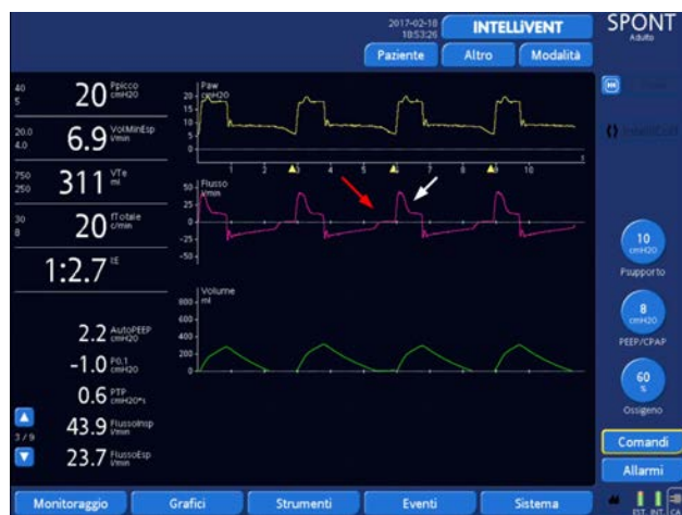
Figura 6: el mismo paciente ventilado con disparo inspiratorio: 2 l/min; sensibilidad de disparo espiratorio: 25 %; rampa: 75 ms (arriba); tras cambiar al disparo por presión: -2 cmH 2 O, pero manteniendo los ajustes previos (abajo). Preste atención al aumento del retraso inspiratorio (flecha roja) y, por ende, al ciclo tardío de espiración (flecha blanca).
