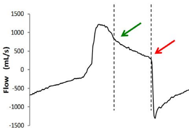
Figura 4: la revisión de la onda relativa al flujo puede indicar el final de la actividad inspiratoria del paciente (flecha verde). El resto de la fase inspiratoria es pasivo, pues los músculos inspiratorios del paciente ya están relajados. Sin embargo, el respirador sigue inflando los pulmones hasta que se abre la válvula espiratoria (flecha roja). Las líneas discontinuas indican el retraso de la espiración.
