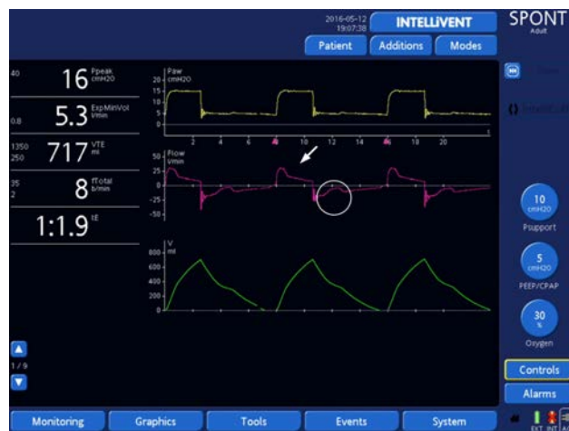
Figura 11: ajuste predeterminado de ETS (25 % del flujo máximo inspiratorio). Preste atención al ciclo espiratorio tardío (flecha) y a los esfuerzos ineficaces (círculo).
