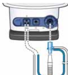
Figura 5-7 Connessione del sensore di flusso alla valvola espiratoria, modalità nCPAP-PS
