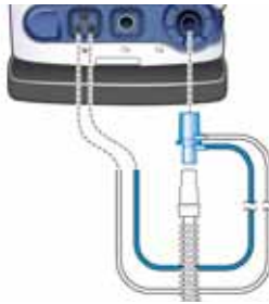
Figura 5-8. Installazione del sensore di flusso, modalità nCPAP-PS
