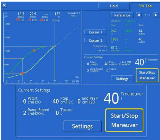
Figura 1: Ajuste de la curva de presión/volumen con P/V Tool Pro
