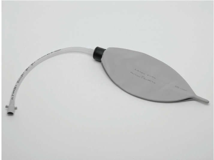
Figura 7-14. Conjunto de pulmón de prueba
