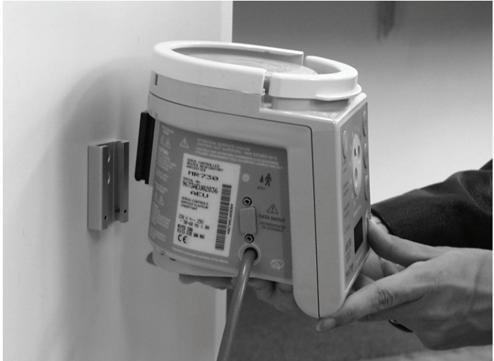
Figura 2-3. Instalación del humidificador
