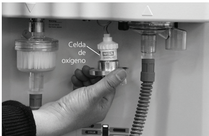
Figura 10-3. Sustitución de la celda de oxígeno
