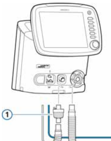
Рисунок 2-1. Установка бактериального фильтра (1)
