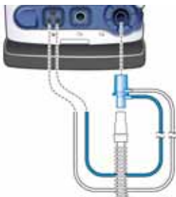
Рисунок 5-8. Установка датчика потока в режиме nCPAP-PS
