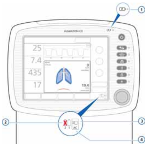
Рисунок 2-14. Обозначения источников питания и индикатор заряда аккумулятора
