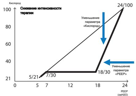
Аппарат регулирует параметры «PEEP» и «Кислород», которые влияют на оксигенацию пациента. В разделе 1.8.3 приведен обзор действий контроллера в зависимости от измененного значения «SpO<sub>2</sub>».
