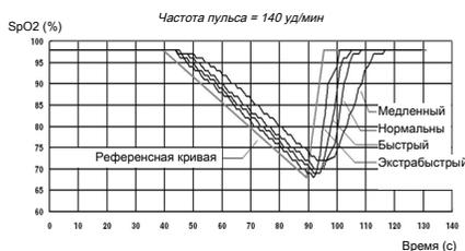
Рисунок 4-3. Время отклика, частота пульса изменяется на 10 уд/мин/с
