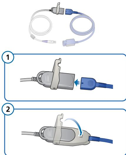
Рисунок 2-6. Отсоединение компонентов пульсового оксиметра Nihon Kohden
