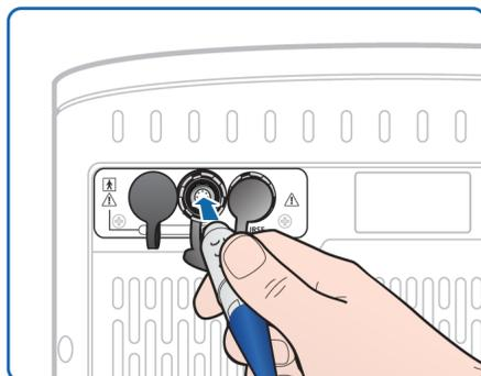
Рисунок 2-5. Подсоединение кабеля датчика к адаптеру Nihon Kohden
