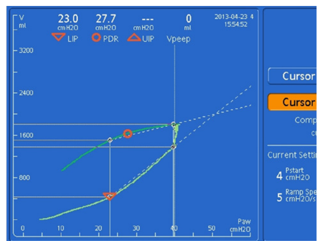
Grafik 2: Die Erhöhung des Lungenvolumens als Ergebnis des Recruitmentmanövers kann mit den Cursors einfach gemessen werden.
