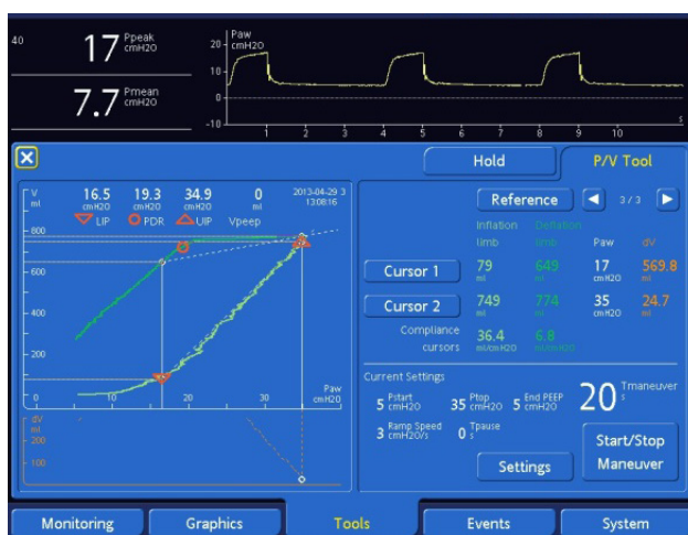
Grafik 1: Eine Cursor-Funktion ermöglicht die grafische Analyse der Kurve, einschließlich Identifikation der Inflektionspunkte.
